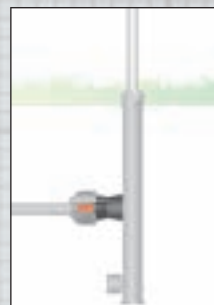
Připojení výsuvného zadržovače S 80/300: Pomocí spojky s vnitřním závitem 3/4" 25 mm č.v. 2761
